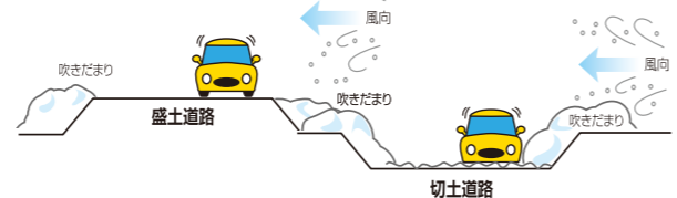
盛土道路と切土道路での吹きだまりの様子
