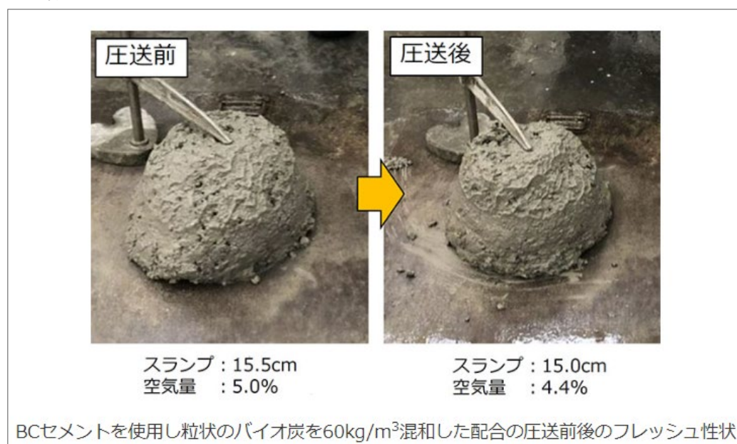
図 3-14 コンクリートの様子
