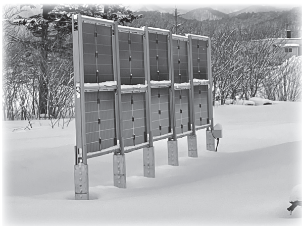
プール横の町有地では縦型のソーラーパネルを設置し、調査・研究を行っています。
