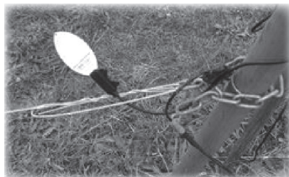
葉面の水分量を測定する装置です
